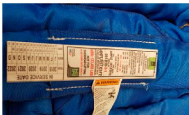
Ejemplo etiquetas y tabla de colores de eslingas TPR
