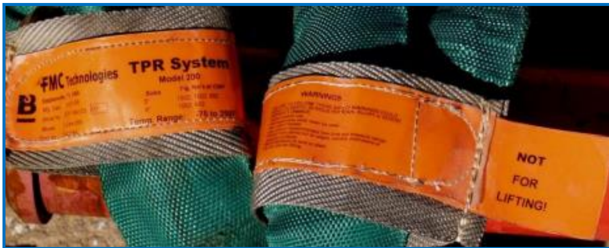
Ejemplo etiquetas de eslingas TPR
