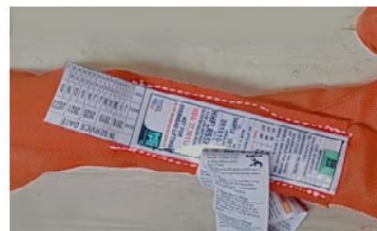
Ejemplo etiquetas y tabla de colores de eslingas TPR
