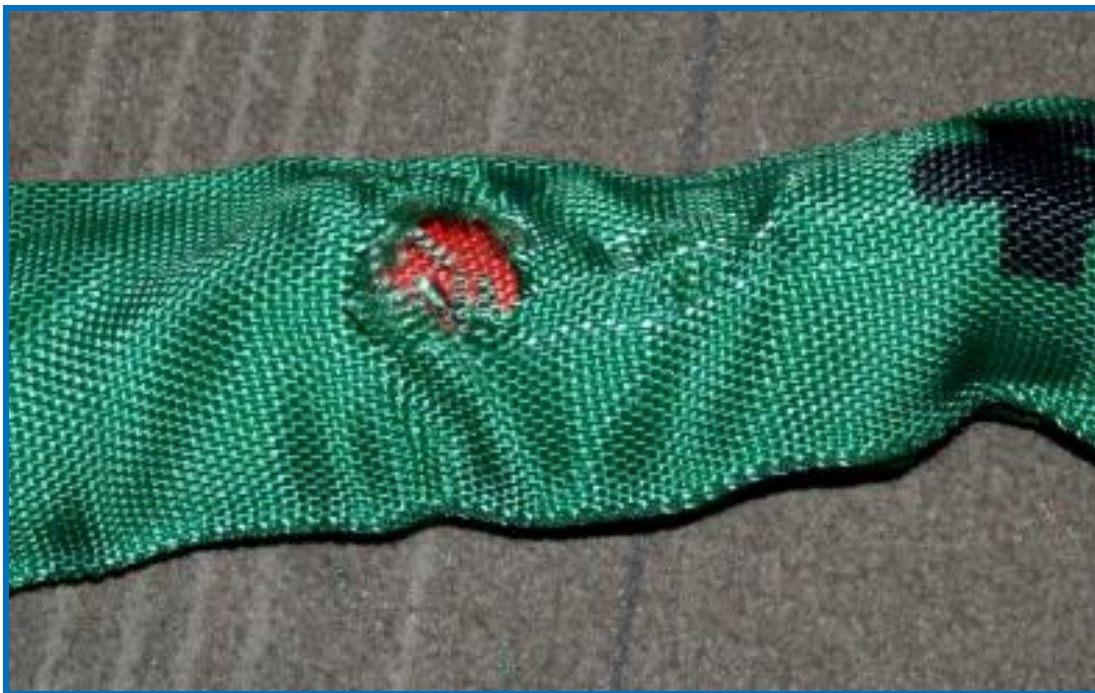
Cubierta externa dañada que expone la cubierta interna roja
