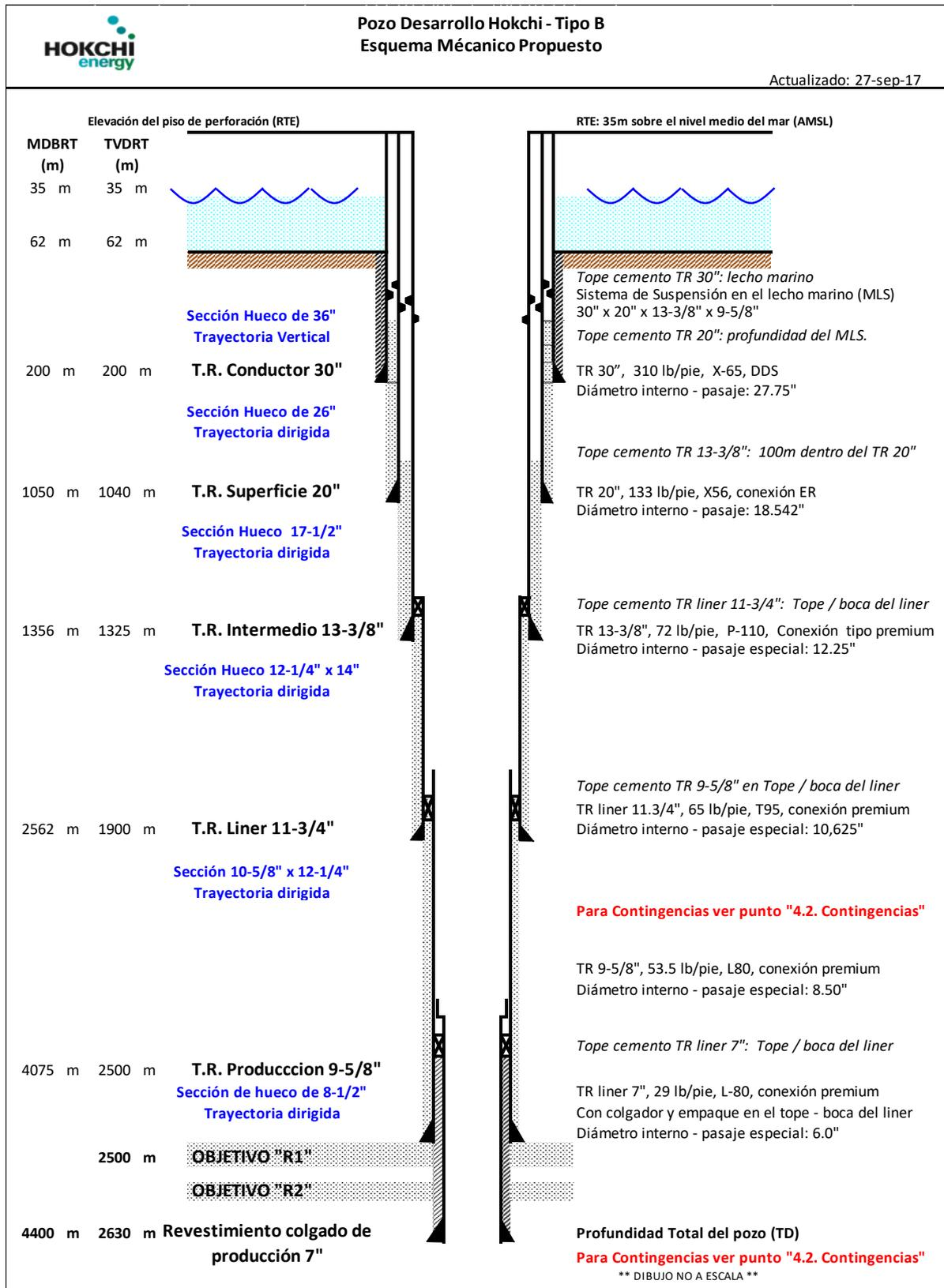
**Figura 11 - Esquema de pozo**
