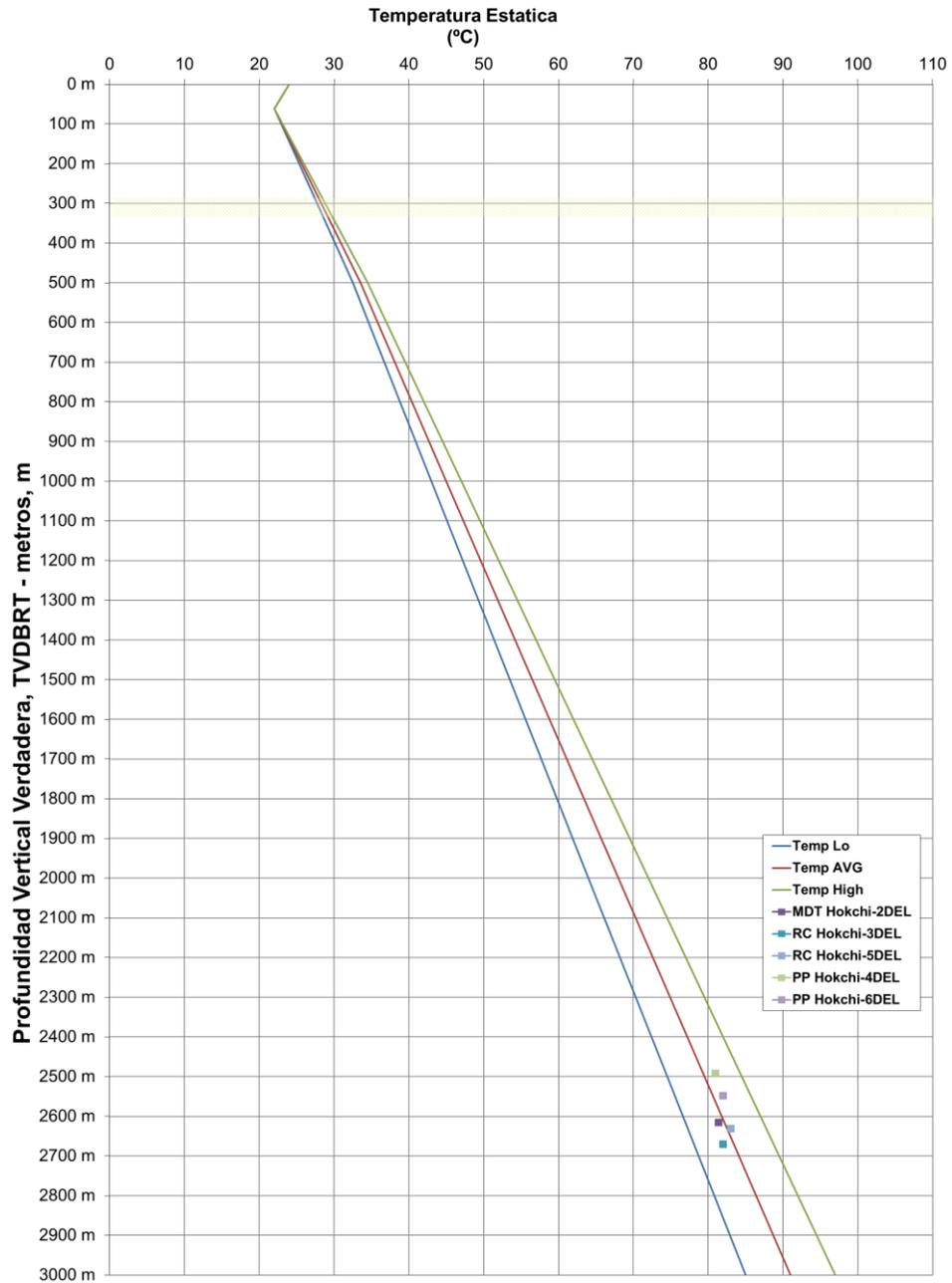
**Figura 4 – Perfil de temperatura estático en campo Hokchi**
