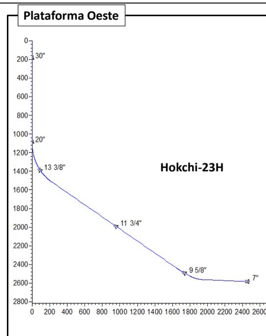
**Figura 8 - Sección Vertical Hokchi-23H**
