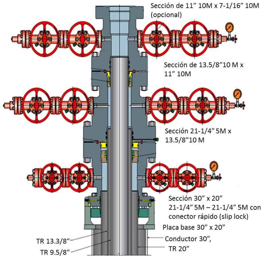
**Figura 10 - Cabezal de pozo: 30" x 20" x 13 3/8" x 9 5/8"**
